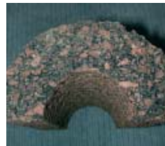
Rohrisolierung aus Teerkork
