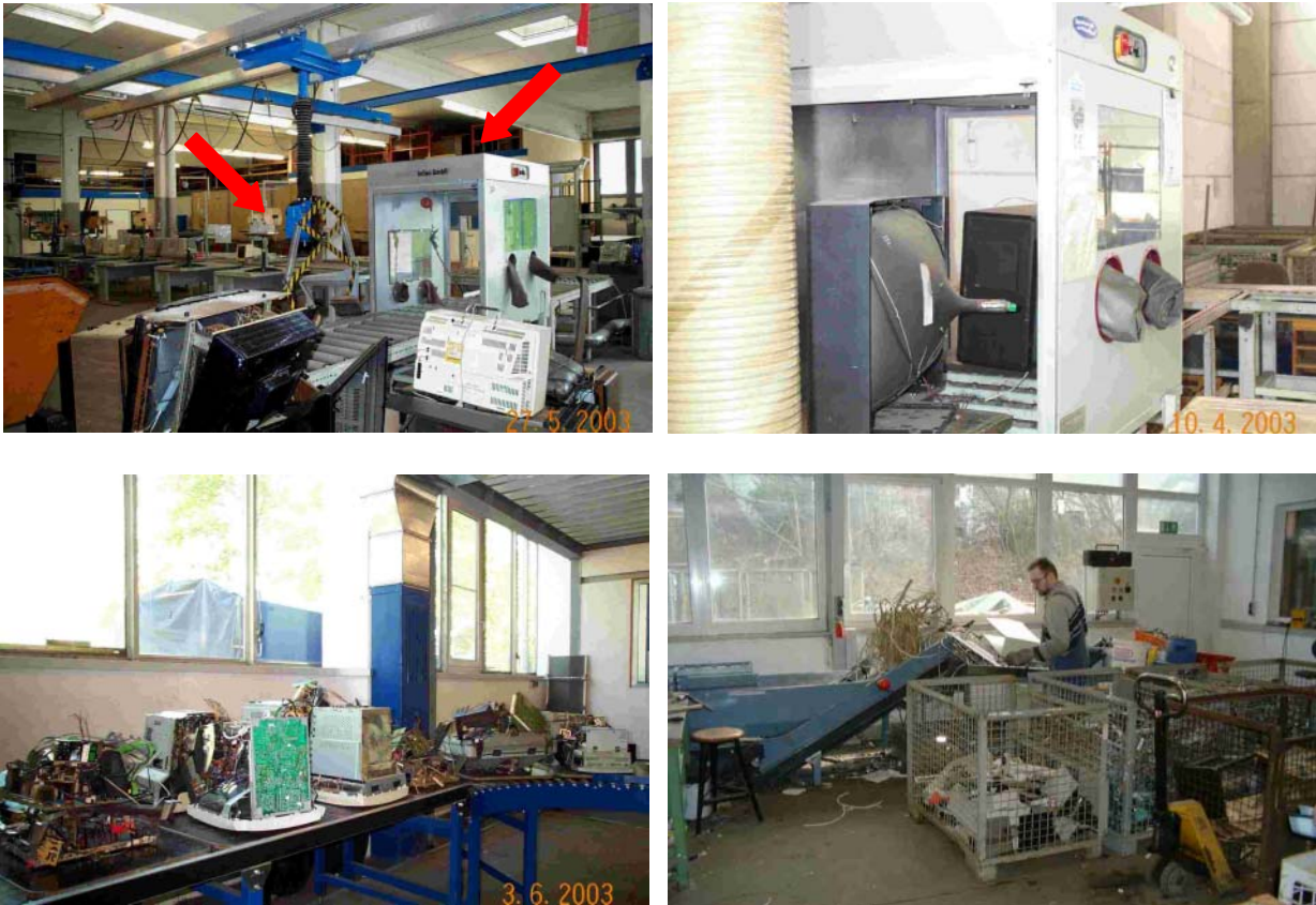
Abbildung 3.13: Demontage von Elektro(nik)-Altgeräten entlang eines Rollbandes
